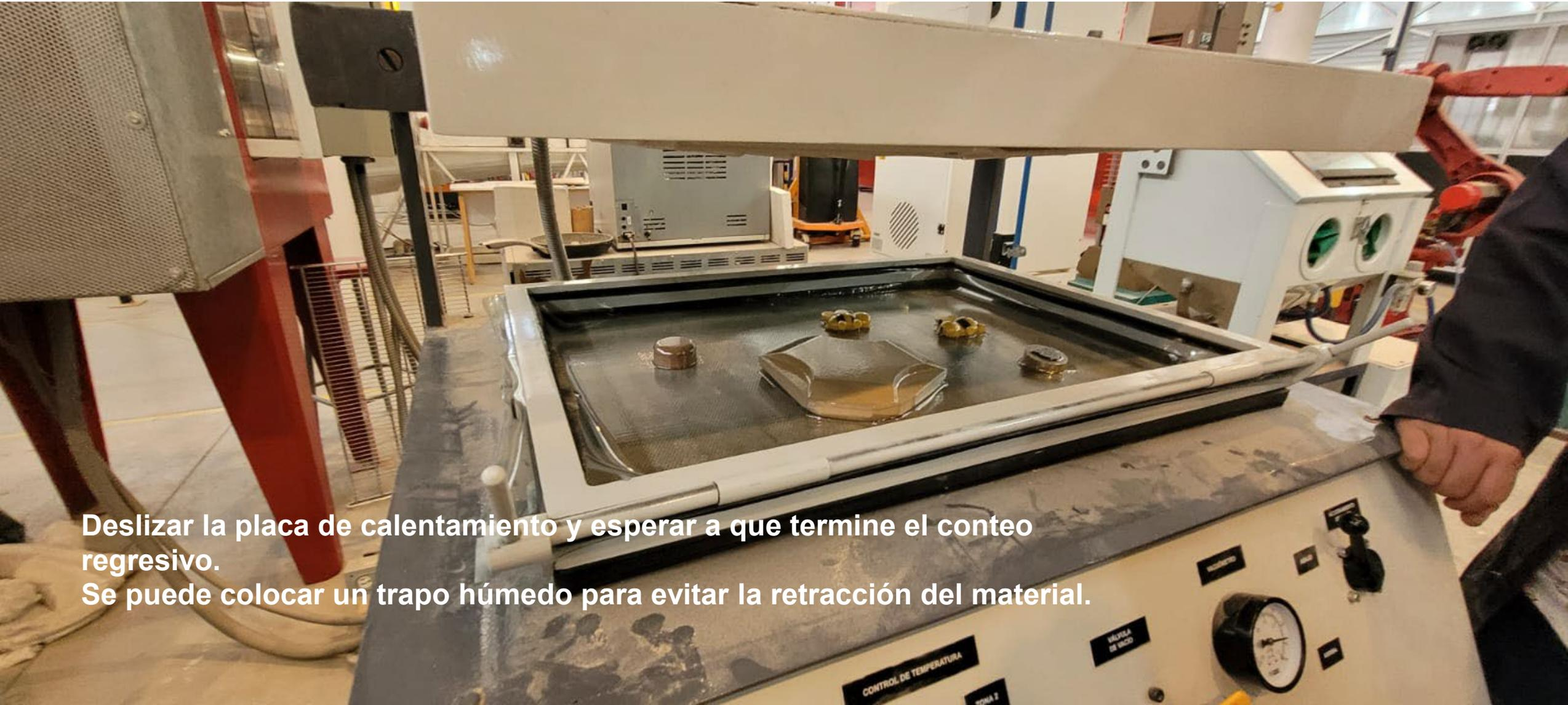
Deslizar la placa de calentamiento y esperar a que termine el conteo regresivo.
