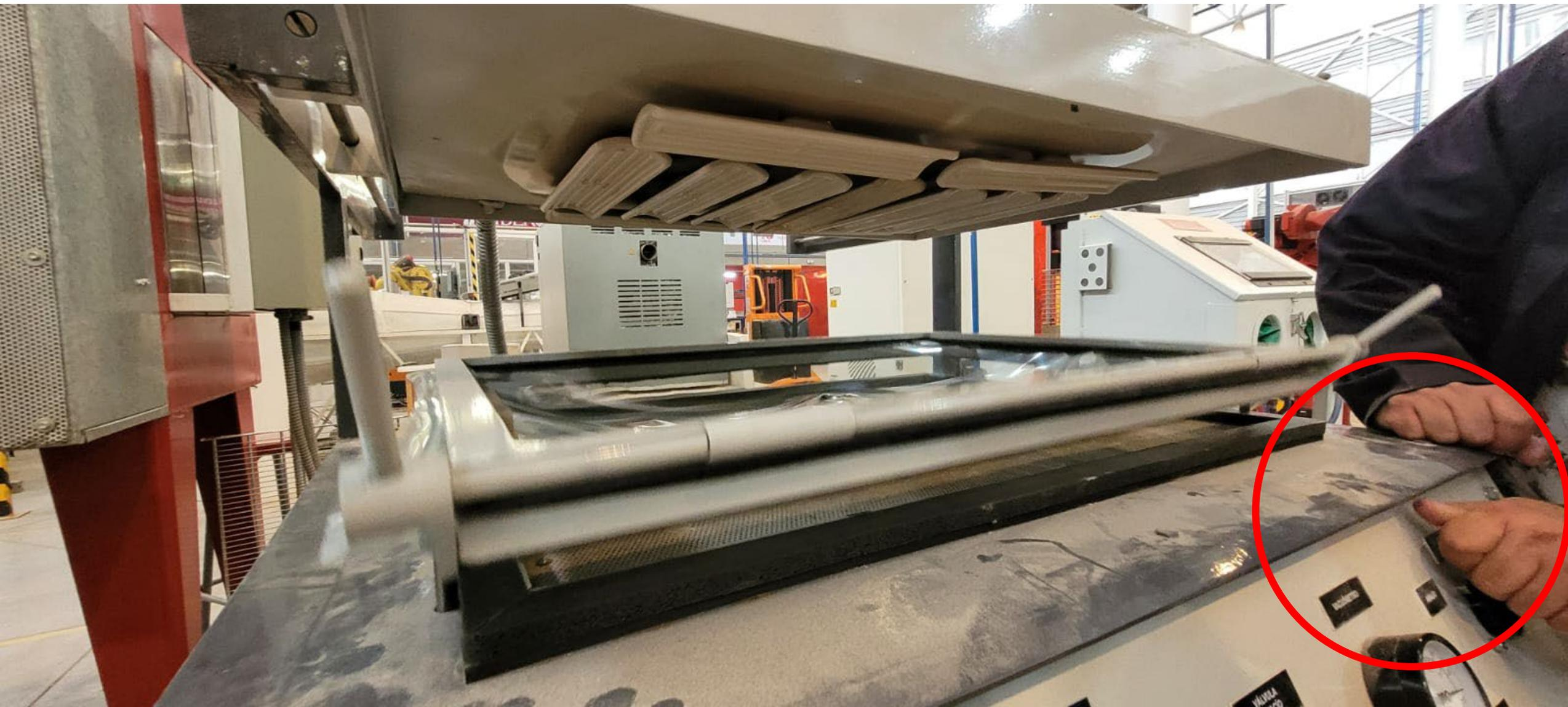
6. Abrir la válvula de vacío.
