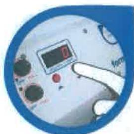
Ajuste el temporizador a cero utilizando el botón DOWN.<sup>(2)</sup>
