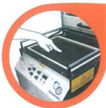
Encienda el vacío y coloque el dedo encima del hueco de vacío.
