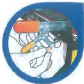
Dependiendo del grosor del plástico puede que necesite utilizar los tornillos de ajuste en las abrazaderas para sujetar adecuadamente el plástico.
