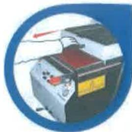
Mueva el calentador hacia la posición delantera sobre el plástico. Al calentarse el plástico este empieza a elevarse ligeramente. A continuación, se ablanda y empieza a bajar.
