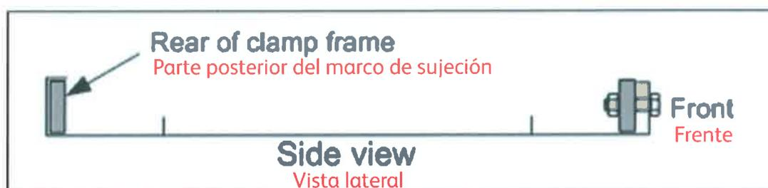
4. Cierre el marco de sujeción. Compruebe que los marcos superior e inferior están alineados. Ajuste el material de plástico en la placa reductora inferior. Será necesario ajustar las abrazaderas de modo que el marco de sujeción pueda cerrarse para conseguir la presión de cerrado necesaria
