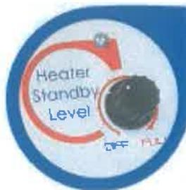
Ajuste el nivel de *standby* del calentador sobre el 30 %.
