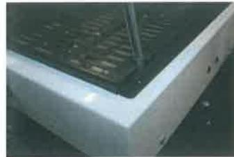
Quite los 4 tornillos que sujetan la cubierta negra en la parte superior del calentador.
